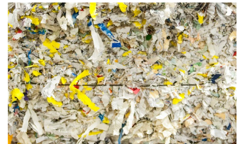
Chez PK, les déchets de bureaux triés sont la principale matière première pour la fabrication de fibres recyclées. Les déchets sont désencrés et réduits en pâte à notre usine de Crabtree, au Québec.
